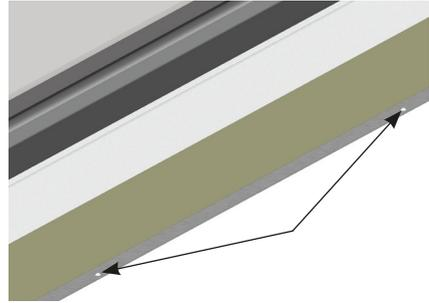
Die Bohrungen für die Befestigungsmittel sind bereits in der Konstruktion des Dachausstieges vorhanden. Für den jeweils vorhandenen Untergrund sind geeignete Befestigungsmittel zu wählen und den Dachausstieg damit fixieren. Eine Liste der Befestigungsmittel ist in der separaten Montageanleitung zu finden.
