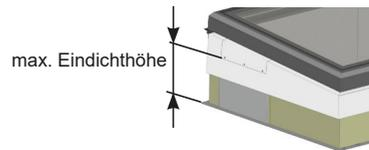
Die maximalen Eindichthöhen von 300mm (beim Dachausstieg Swing) bzw. 340mm (beim Dachausstieg Quadrat) dürfen nicht überschritten werden. Nur so bleibt der ungehinderte Zugang zur Revisionsöffnung gewährleistet.
