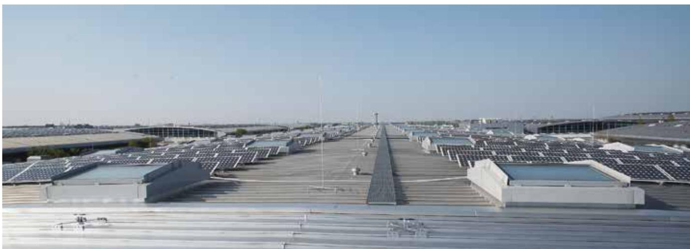
Das Tageslichtelement LAMILUX CI-System Rauchlift TWIN bietet gleich doppelte Sicherheit für Industriegebäude. Das Produkt ist als Doppelklappe konzipiert und kann mit den Abmessungen bis zu 3 mal 3 m gefertigt werden. Es bietet also bis zu 9 qm Rauchaustrittsfläche – ein Garant für hohe Sicherheit im Brandfall. Natürlich lässt es sich flexibel in 5-Zentimeter-Schritten unterschiedlichsten Größenanforderungen anpassen, insgesamt ist es in 1.600 Abmessungen lieferbar.
