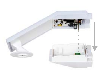
Abb. 20 Stecken Sie den Deckel auf das Unterteil. Dabei wird die Steckverbindung zwischen der Platine im Deckel und der Anschlussbuchse im Unterteil her- gestellt.
