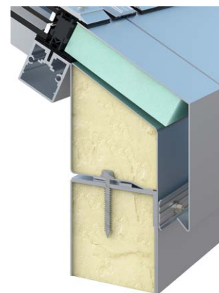
Montage auf Stahlblechzarge
